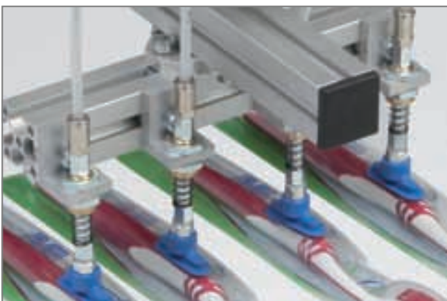
Flachsauggreifer SGON bei der Handhabung von Blister-Verpackungen
