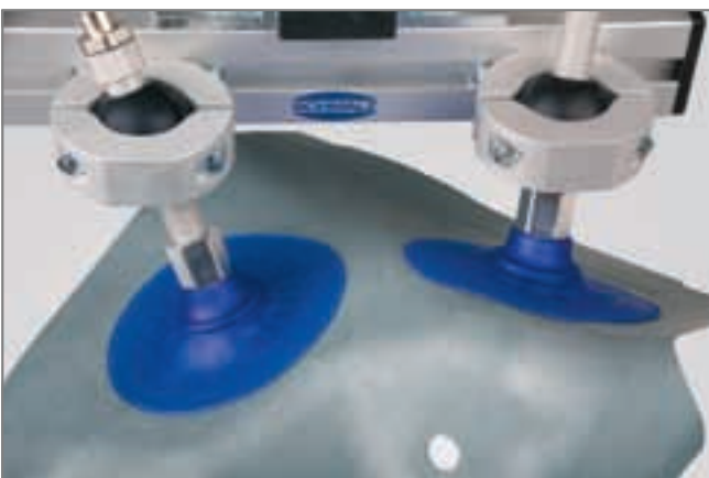
Sauggreifer mit Universalhalter HTR-UNI bei der Handhabung von Blechteilen
