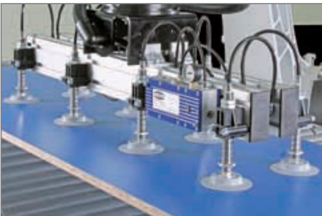
Zentrale Vakuum-Erzeugung durch Mehrstufigejektoren SEM bei der Handhabung von beschichteten Holzplatten
