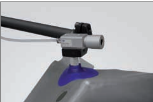
Dezentrale Vakuum-Erzeugung durch Ejektoren SEAC ECO direkt am Sauggreifer
