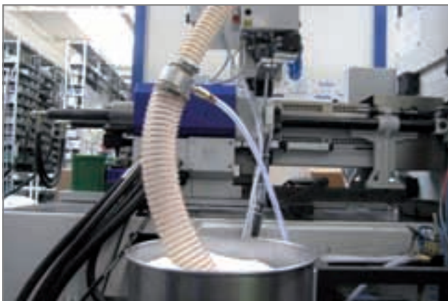
Vakuum-Erzeugung durch Förderejektoren SEC bei der Granulatförderung
