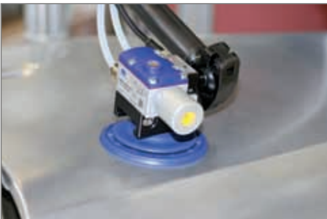
Dezentrale Vakuum-Erzeugung durch Ejektoren mit Abwurfsystem SEAC RP direkt am Sauggreifer
