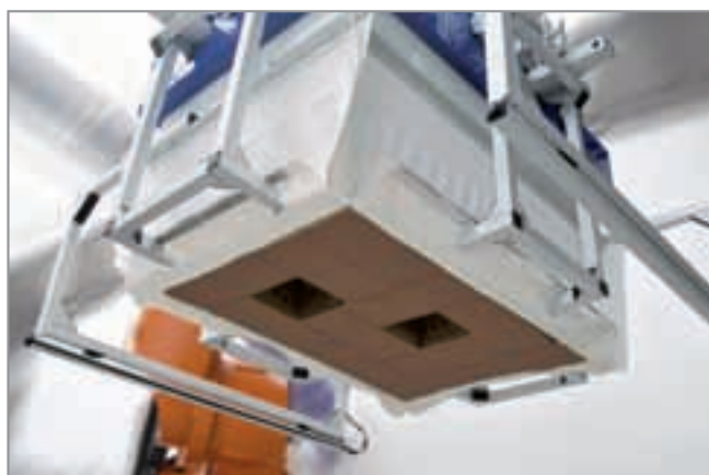
Vakuum-Lagengreifsystem SPZ-M-C mit mechanischer Klemmung und Vorhang
