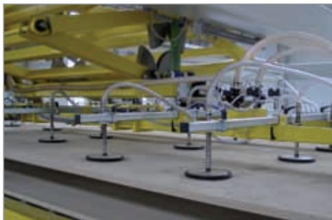
Kundenspezifische Ausführung der Vakuum-Saugspinne SSP mit Saugplatten
