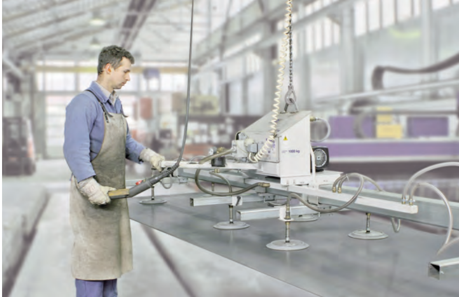
VacuMaster Vario bei der Be- und Entladung einer Laserschneidmaschine
