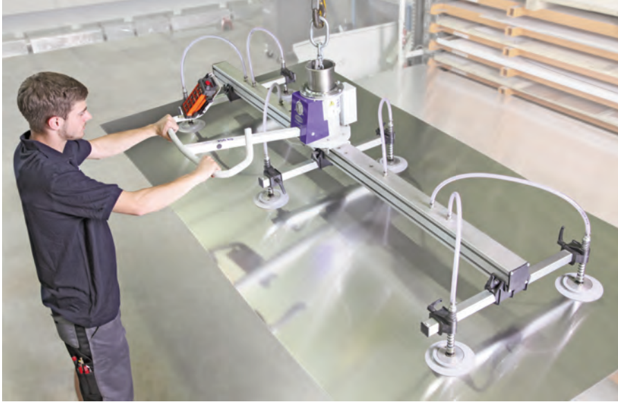
VacuMaster Eco zur Entnahme von Stahlblechen aus einem Schubladenregalsystem
