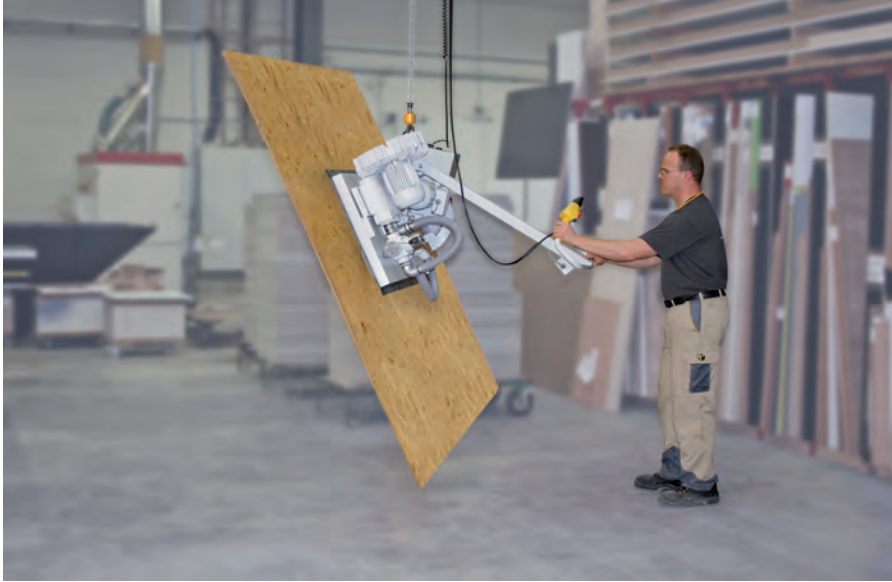
VacuMaster Multi zum Schwenken von Holzplatten um 90°
