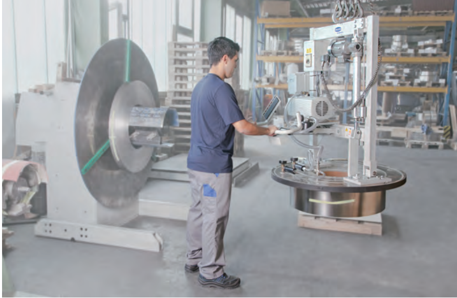
VacuMaster Coil zum Schwenken von Edelstahl-Coils um 90°
