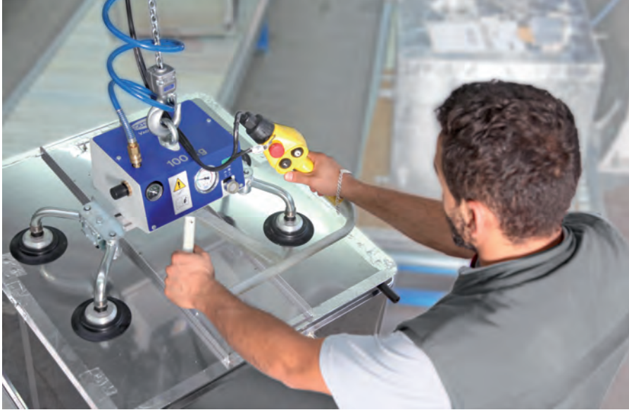
VacuMaster Light zur Handhabung von Metallgehäusen
