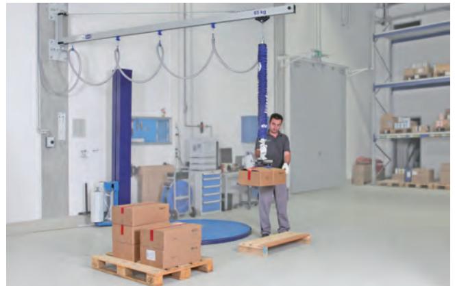
Wandschwenkkran WK mit Vakuum-Schlauchheber Jumbo
