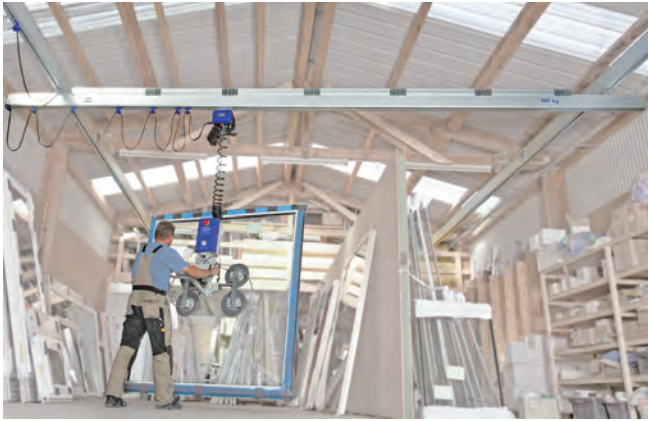
Aluminium-Krananlage SRA mit Kettenzug und Vakuum-Hebegerät VacuMaster
