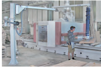
Knickarm-Ausleger zum Umfahren von Störkonturen
