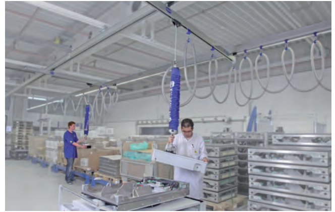
Aluminium-Krananlage SRA mit Vakuum-Schlauchheber Jumbo
