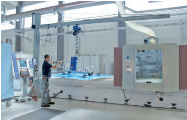
Säulenschwenkkran SK mit Kettenzug und Vakuum-Hebegerät VacuMaster
